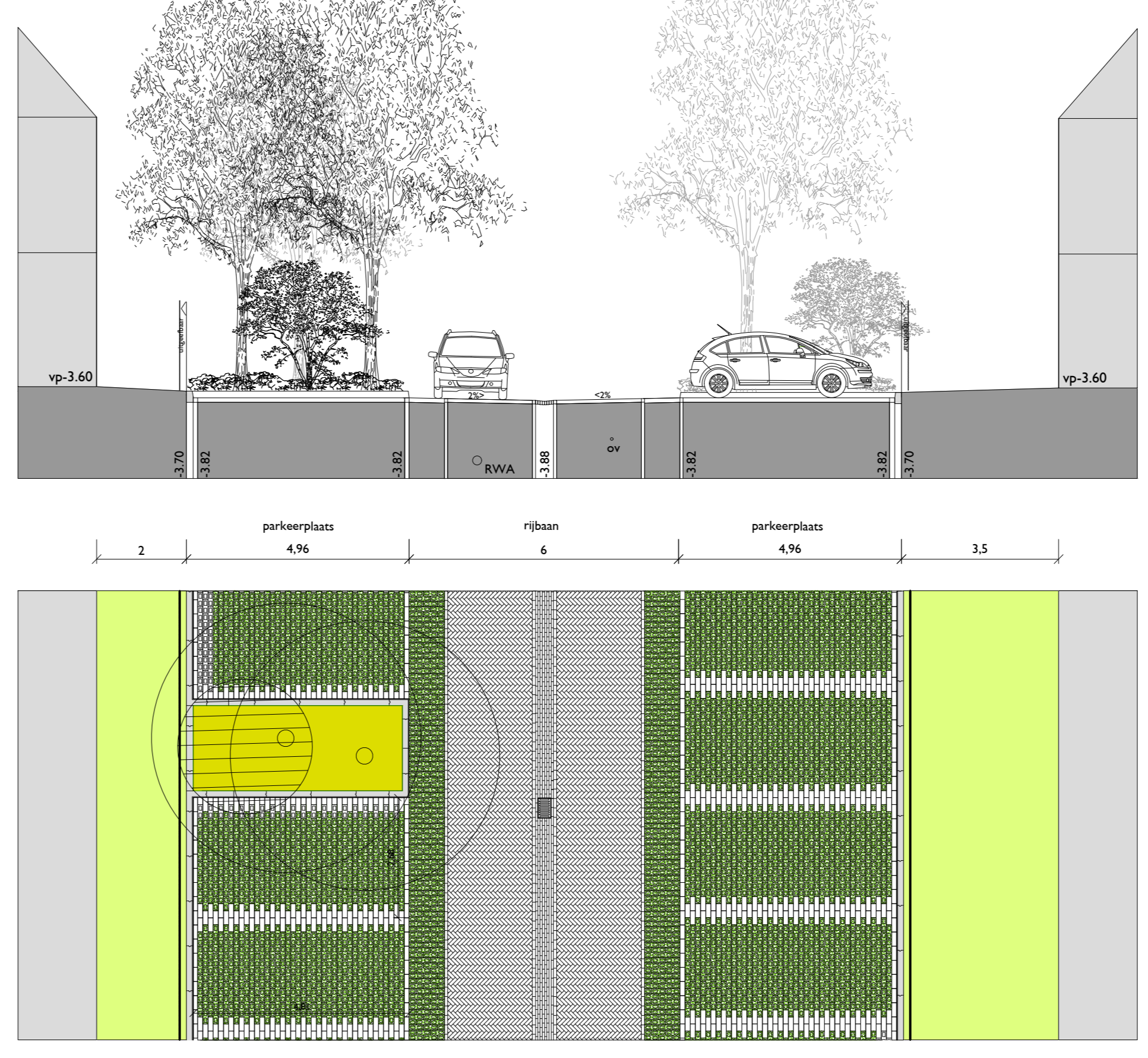
Profiel: P-P' Parkeerkoffertje Aandachtspunt: afmetingen NCB-steen bepalend voor breedte/diepte parkeervak
